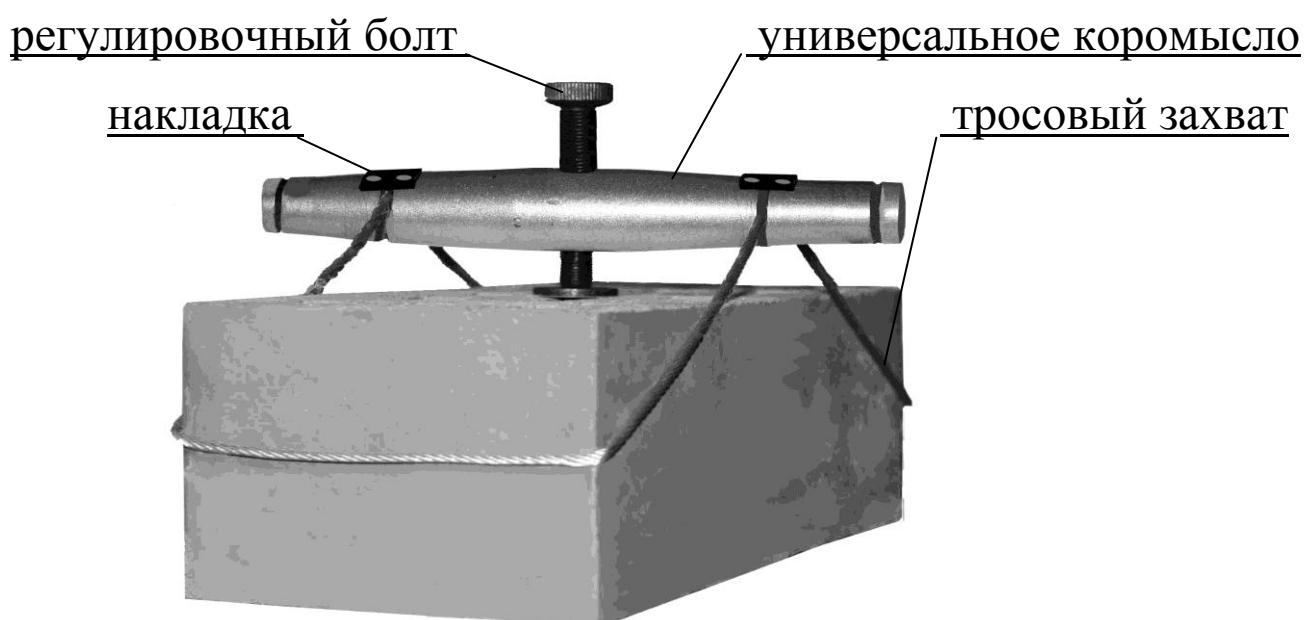
Рисунок 2 – Схема захвата кирпича, подготовленного к испытанию
