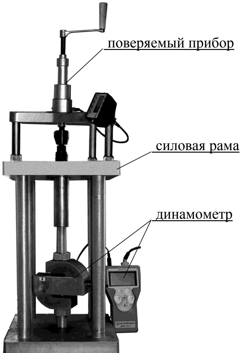
Рисунок 9 –Установка прибора при поверке
