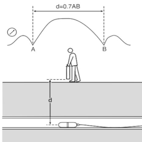
Если сигнал слишком слаб или неустойчив, то локатор не будет рассчитывать глубину. В этом случае, используйте более мощный зонд или порядок точного определения местоположения, описанный ниже.
