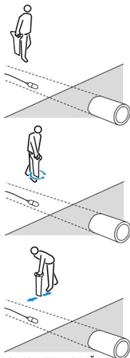
Повторяйте каждый этап с последовательным уменьшением движений, установив локатор на землю или держа его прямо над ней. Локатор теперь должен быть прямо над зондом и параллельно зонду. Отметьте это местоположение.
