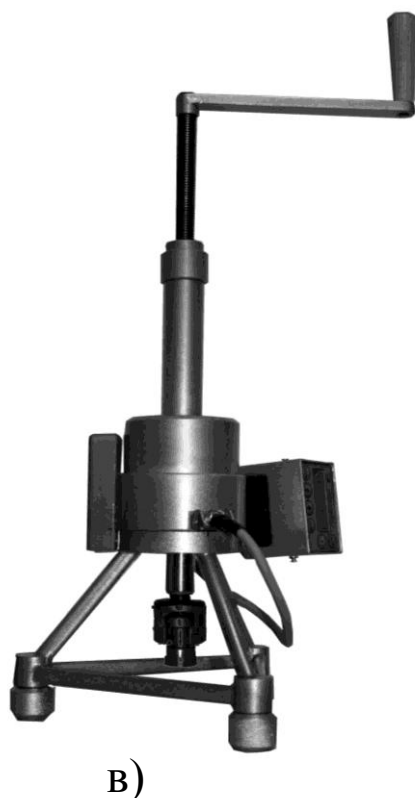
Рисунок 1.1 – Внешний вид измерителей прочности бетона ПОС-50МГ4
