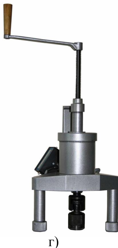
Рисунок 1.1 – Внешний вид измерителей прочности бетона ПОС-50МГ4
